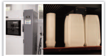
Sistema de fabricación Fortus 400 mc., de Stratasys (izquierda) y fabricación de prototipos en Policarbonato (derecha). Manufacturing System Fortus 400mc, from Stratasys (left) and manufacturing prototypes in polycarbonate (right).
