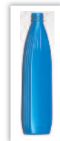
Diseño final con rigidizadores estructurales (DS). Final design with structural stiffeners (SS).
