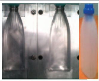
Molde piloto y uno de los envases fabricados en él. Pilot mould and the packaging produced from it.
